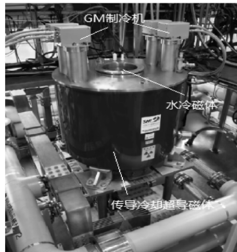
图 2 29 T 制冷机传导冷却的混合型超导磁体系统结构示意图 [30]
